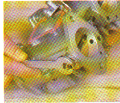
12 Déposez les bouchons d'extrémité de l'axe des papillons et graissez légèrement le roulement. Ne sortez l'axe que s'il s'avère faussé, pour le changer.
